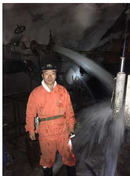
定向钻孔放水现场
