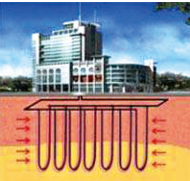
建筑物下地源热泵测试及施工技术
